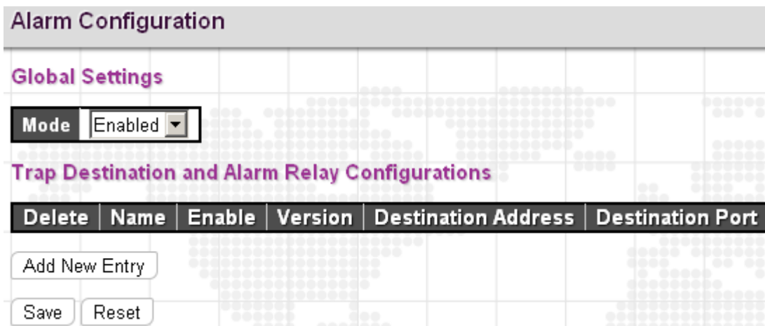
Рис. 47. Вид меню Security – Switch – SNMP - Alarm Configuration
