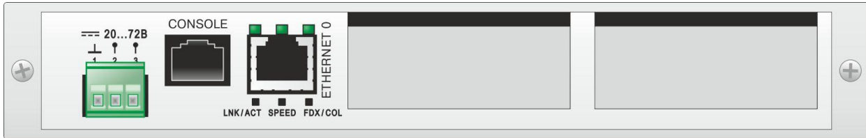
Рис. 27. Вид задней панели изделий MM-221x-I-DC60 и MM-222x-I-DC60 для установки в конструктивы P-12 и P-510 с питанием от сети постоянного тока
