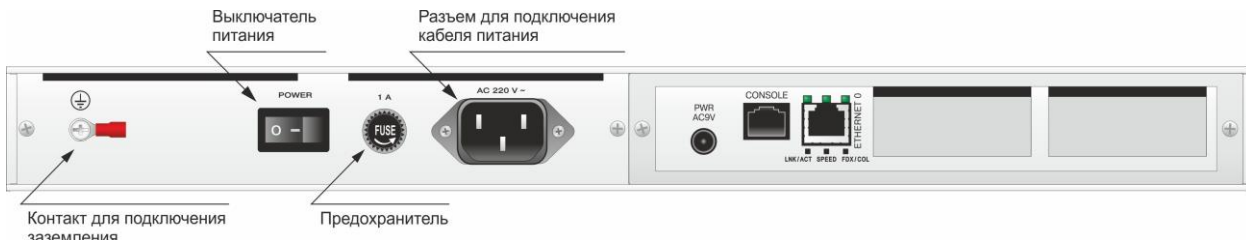
Рис. 28. Вид задней панели изделий MM-221x-T и MM-222x-T в металлическом корпусе 19"
