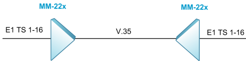
Рис. 22 Пример схемы передачи частичного потока E1 через V.35
