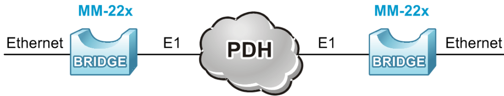
Рис. 2 Пример схемы для передачи Ethernet через E1 в режиме моста
