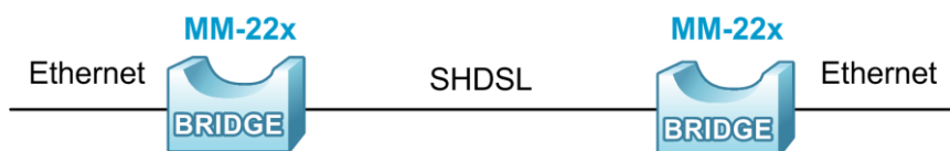
Рис. 20 Пример схемы передачи Ethernet через канал SHDSL
