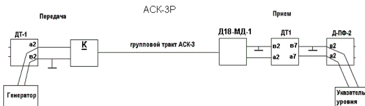
Рис.1. Схема измерения АЧХ в АСК-3Р.
