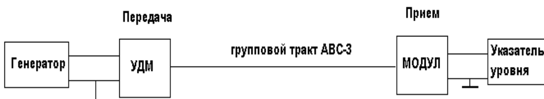
Рис.1. Схема измерения АЧХ в АВС-3.
