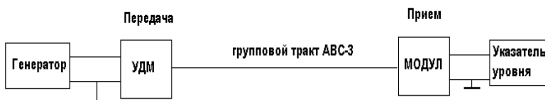
Рис.1. Схема измерения АЧХ в АВС-3.
