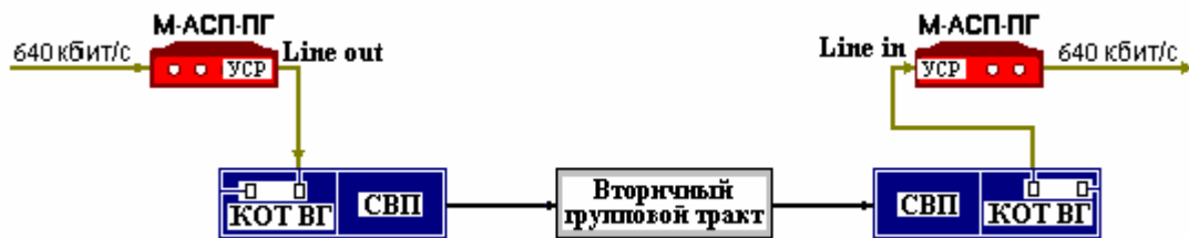
Рис. 16. Схема подключения модемов версий ВГн (ВГв) к тракту ВГ.
