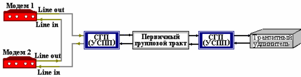
Рис. 24. Схема проверки работы модемов версии ПГМ по шлейфу ПГТ.
