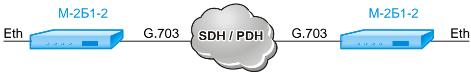
Рис. 6 Использование модема в сети передачи данных SDH/PDH
