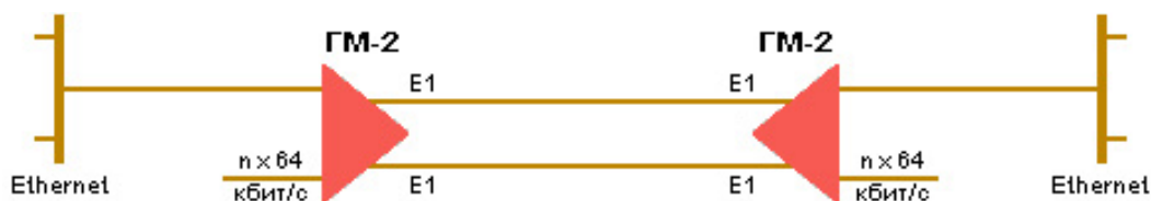
Рис. 3. Режим инверсного мультиплексора при синхронной работе портов А и В
