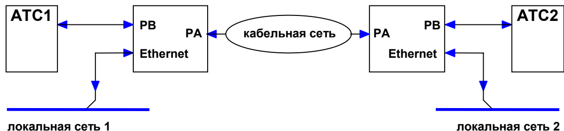
Рис. 23 Пример построения сети на основе мультиплексоров ГМ
