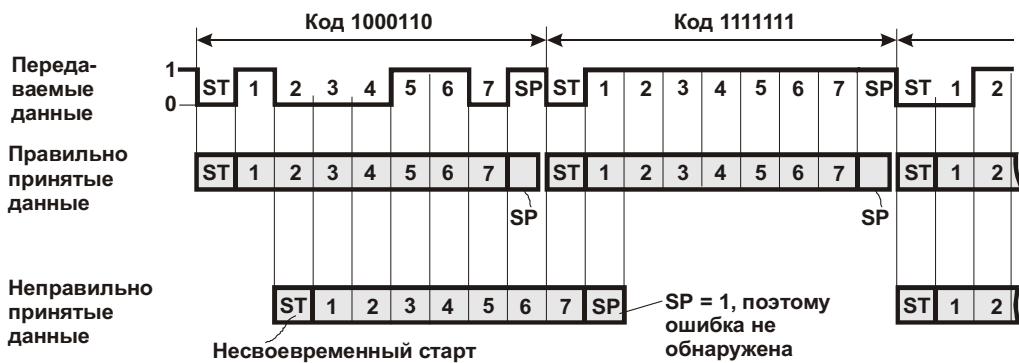
Рис. 3.43. Восстановление правильной синхронизации без обнаружения ошибки. ST и SP – старт- и стоп-биты информационных посылок
