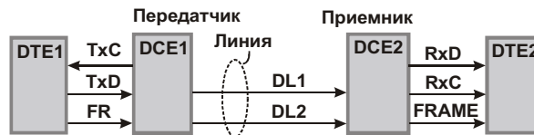
Рис. 3.19. Система передачи данных, использующая дополнительный канал связи для передачи кадровых меток
