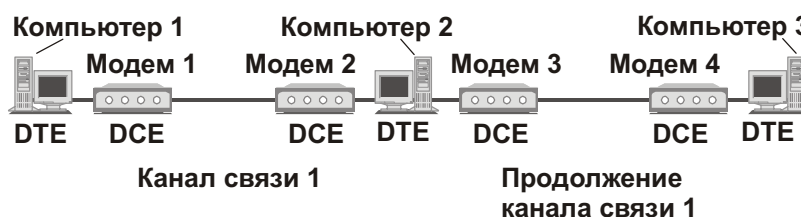
Рис. 1.2. Расширенная система передачи данных
